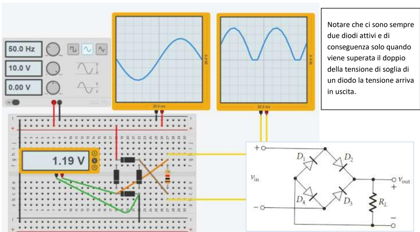
Notare che ci sono sempre due diodi attivi e di conseguenza solo quando viene superata il doppio della tensione di soglia di un diodo la tensione arriva in uscita.
