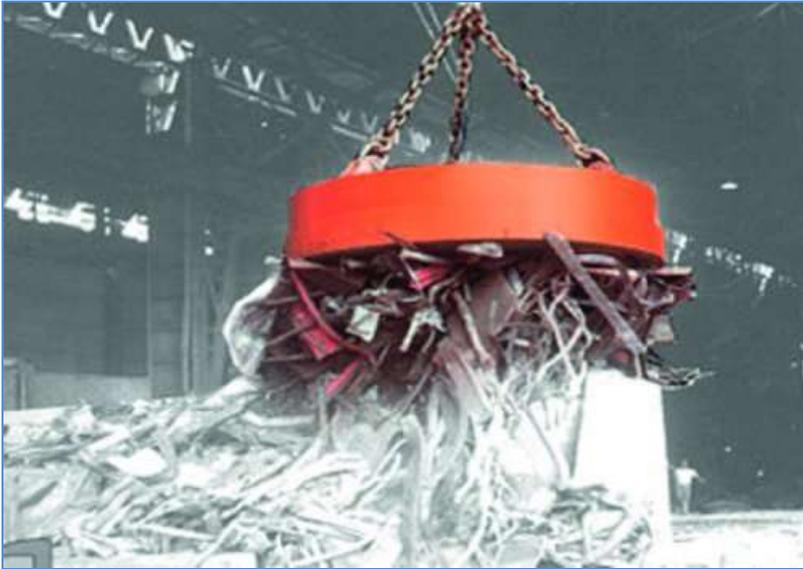
Un elettromagnete è costituito da un numero N di solenoidi collegati in parallelo in modo da moltiplicare la forza di attrazione del singolo solenoide.
