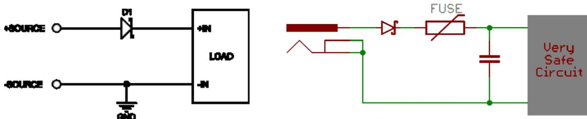
La presenza del fusibile garantisce la protezione del diodo che se sottoposto a tensione negativa per molto tempo si brucerebbe.
