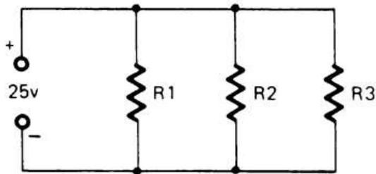
Un circuito parallelo è composto di resistenze ramificate. Ogni diramazione è detta ramo.
