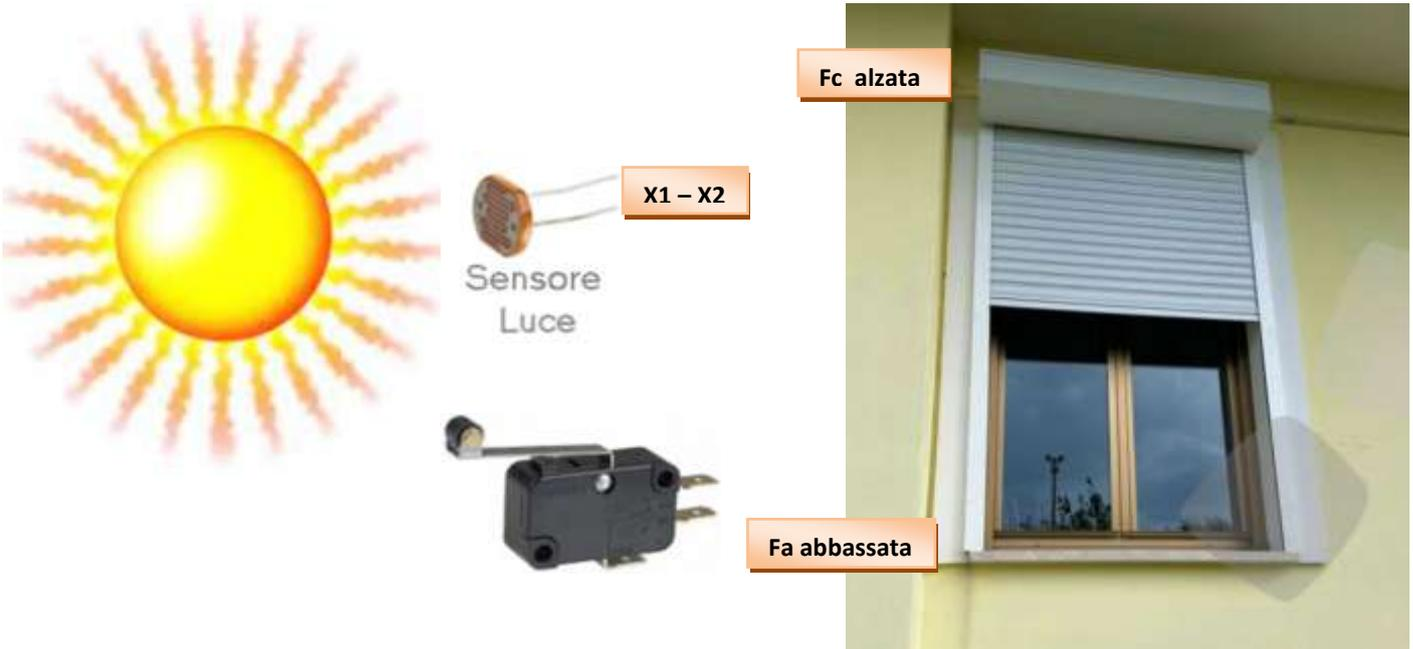
Il sistema impiega un sensore S per rilevare l'intensità luminosa (e un ADC a 2 bit per ottenere 4 livelli di luce) e due finecorsa meccanici Fa e Fc per sapere se la tapparella è ABBASSATA o ALZATA.
