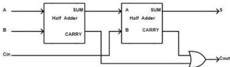
Sulla base delle due equazioni di cui sopra, il circuito sommatore completo può essere implementato utilizzando due mezzi sommatore e una porta OR. Di seguito è mostrata l'implementazione del sommatore completo utilizzando due mezzi sommatore.
