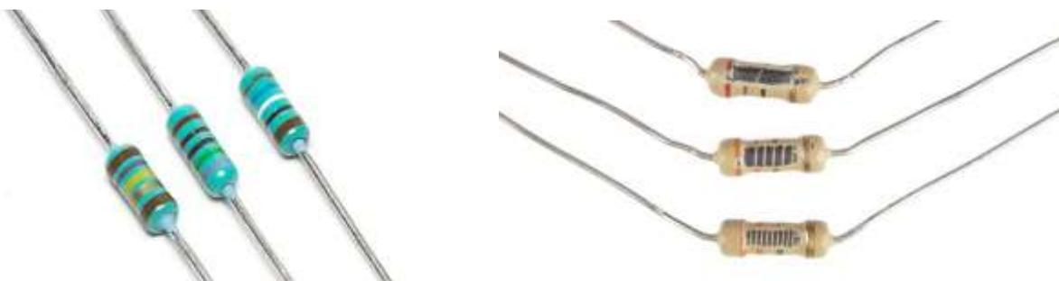
Nel caso in cui i resistori non abbiano i valori numerici stampati su di essi, si utilizza un codice a colori, che per i resistori fissi sono definiti dalla EIA, tramite la "Tabella codici colori EIA-RS-279".
