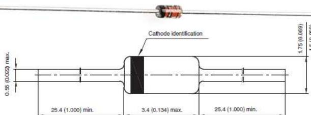
Un diodo 1N4148. Si noti il cerchio nero attorno al diodo, che marca il terminale del catodo.
