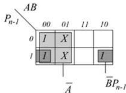
In questa tabella, oltre ad A e B si tiene conto dello stato precedente del motore della pompa; il motore si accende quando  $A=B=0$  e si spegne solo quando  $A=B=1$ , quindi se siamo nella fase di riempimento  $A=1$  e  $B=0$  con  $P=1$ , P deve restare tale.
