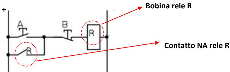
Schema Simulide per accensione con autoritenuta di una lampada tramite RELE'.
