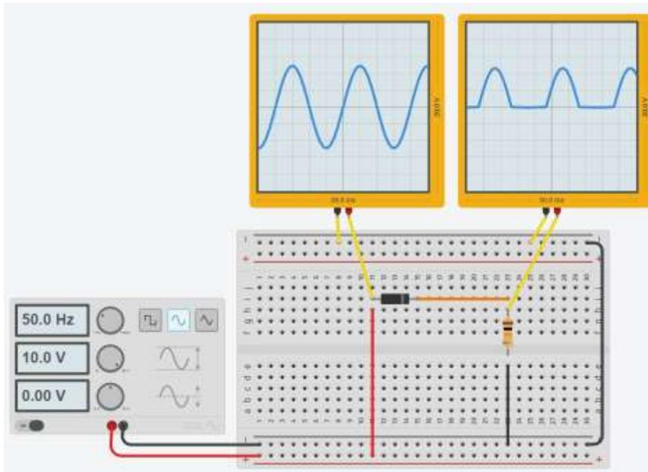
Notare che il diodo inizia a condurre quando viene superata la sua tensione di soglia (es. 0.7V) e di conseguenza non tutta la semionda positiva arriva in uscita.
