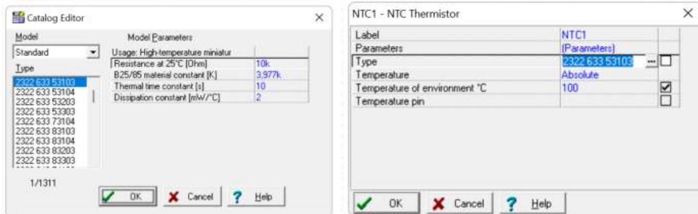
Facciamo variare la temperatura del termistore da 10 a 100C con passo 10C. Prendiamo nota della tensione in uscita.
