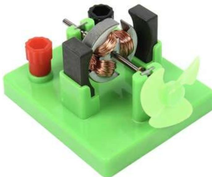
Collegare un alimentatore da laboratorio ai morsetti + e - e un amperometro per controllare la corrente assorbita.
