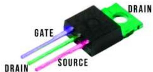
Il principio fisico su cui si basa è diverso rispetto a quello del BJT. I terminali sono sempre tre, cambiano solo i nomi: qui abbiamo gate, drain e source.
