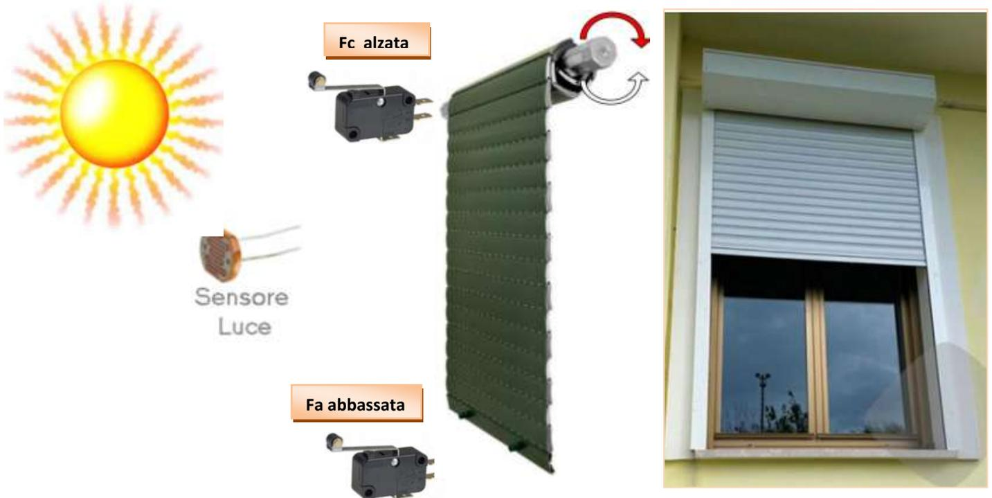
Il sistema impiega un sensore S per rilevare l'intensità luminosa e due finecorsa meccanici Fa e Fc per sapere se la tapparella è ABBASSATA o ALZATA.
