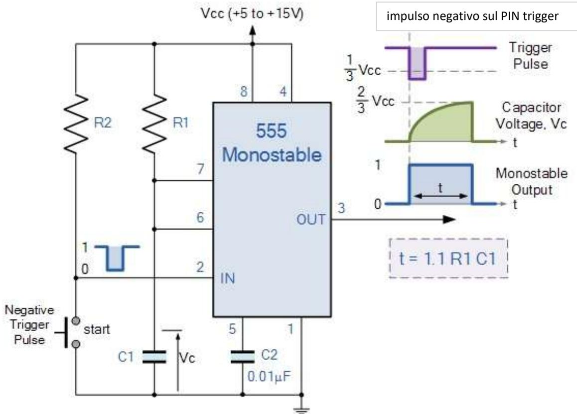
Circuito in Simulide con temporizzazione di 5,5 secondi.
