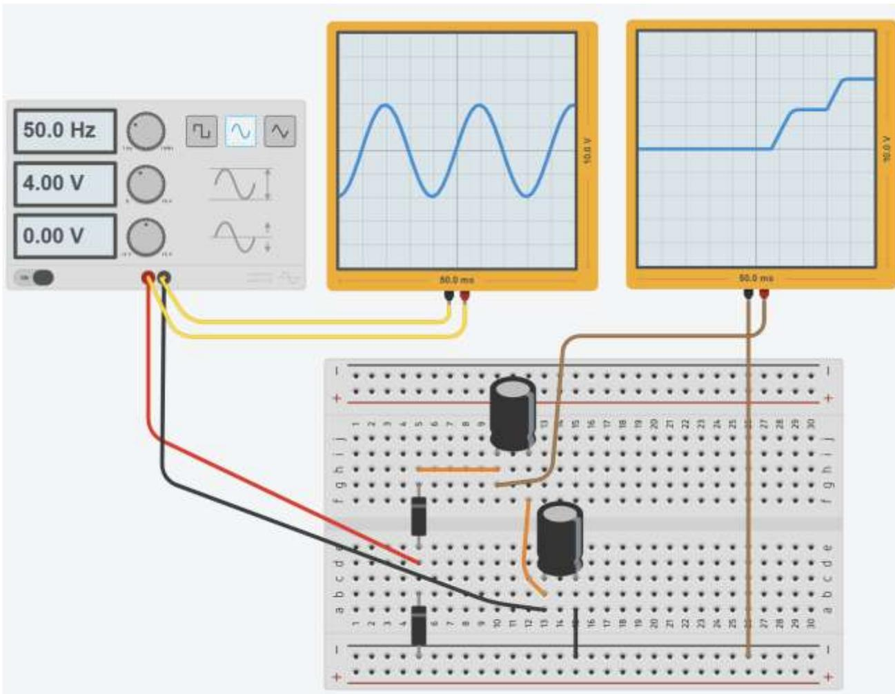
Se all'uscita applichiamo un carico (es. resistenza + diodo rosso) l'assorbimento di corrente porta a una riduzione della tensione in uscita tanto più alta quanto maggiore è la corrente assorbita.
