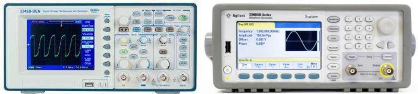
L'oscilloscopio è uno strumento di misura elettronico che consente di visualizzare, su un grafico x-y, l'andamento nel dominio del tempo dei segnali elettrici e di effettuare misure di tensione (rappresentata sull'asse verticale) e del periodo di segnali alternati (il tempo è rappresentato sull'asse orizzontale).
