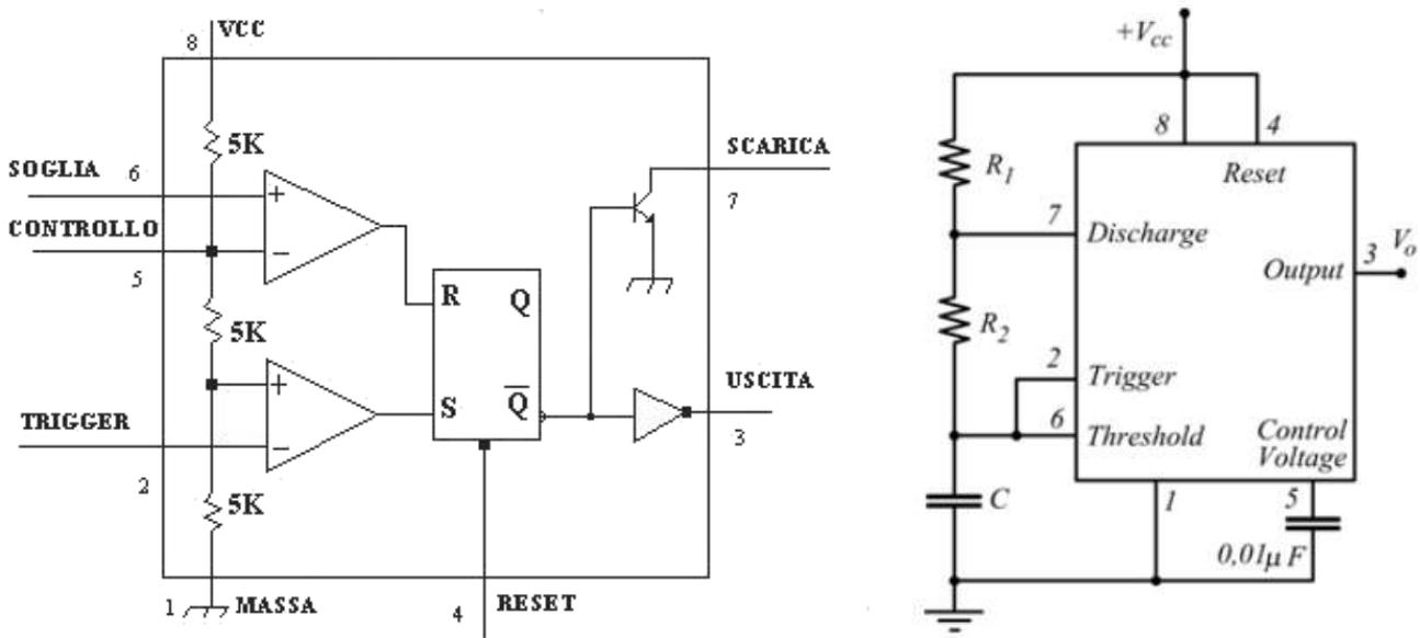
Possiamo subito notare tre resistori uguali da 5K (da qui il nome 555), aventi lo scopo di dividere la tensione di alimentazione  $V_{cc}$  in tre parti uguali e generare due tensioni di riferimento pari a  $1/3 V_{cc}$  e  $2/3 V_{cc}$ .
