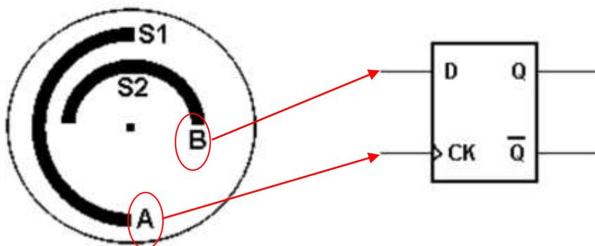
Se il disco ruota in senso orario si ottiene per il bit A e B la seguente sequenza: AB = 00 01 11 10.
