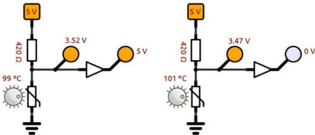
In questo caso quando la temperatura è inferiore a  $100^{\circ}\text{C}$  ottengo un segnale BASSO ( $<3.5\text{V}$ ). Se  $>100^{\circ}\text{C}$  ho segnale ALTO.
