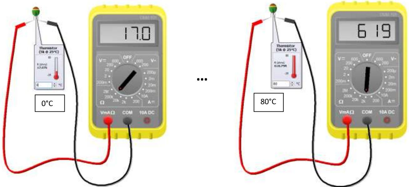
Si chiede di ricavare con EXCEL la curva caratteristica del termistore simulato nelle immagini soprastanti.
