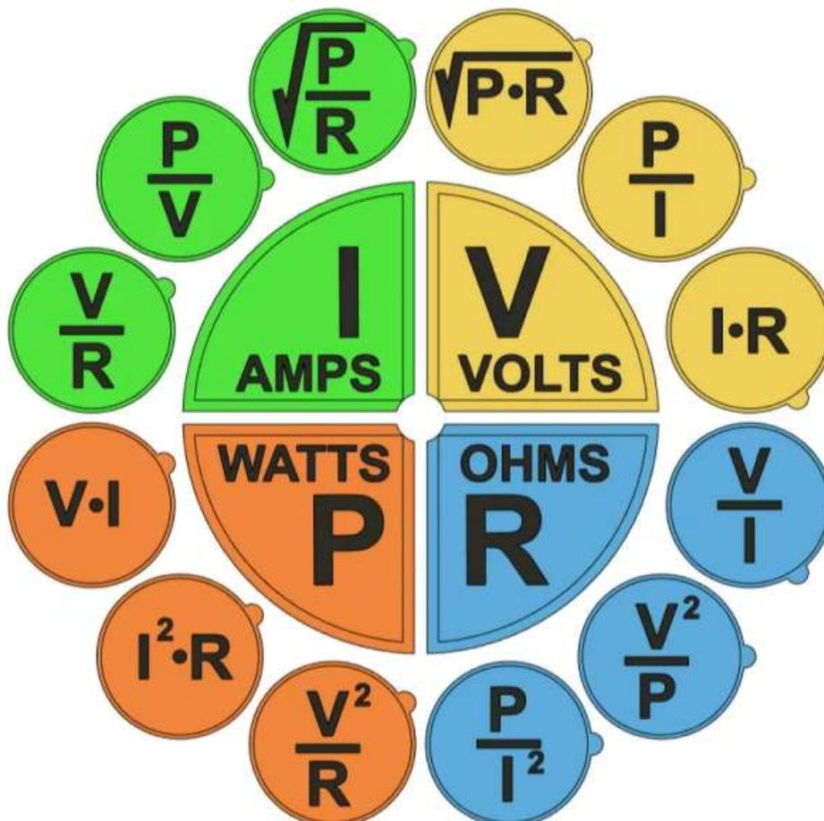
La potenza elettrica in un elemento resistivo viene trasformata in energia termica (calore) → effetto Joule.
