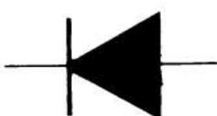
Questo simbolo indica un diodo. La direzione della freccia e la sbarra indicano la sua polarità nel circuito.
