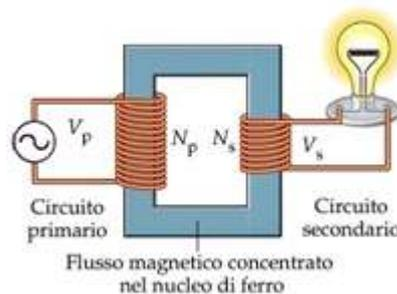
Il trasformatore non cambia la frequenza del segnale in ingresso ma solo l'ampiezza.
