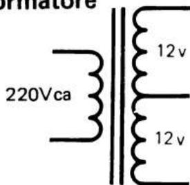
Un trasformatore può avere più di un secondario. Questo trasformatore ha un primario a 220 Vca e un secondario a 24Vca con presa centrale.
