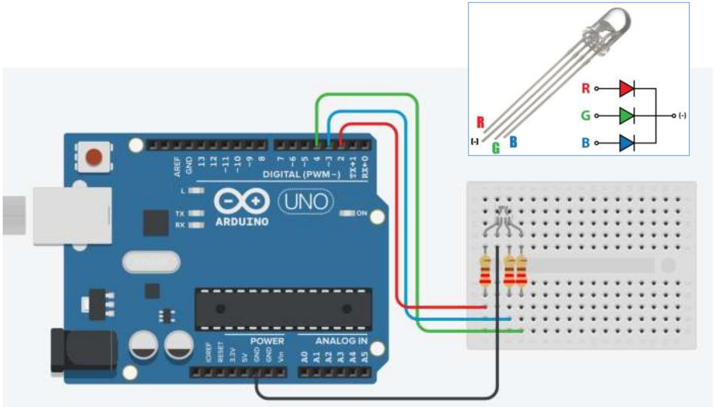
Il codice sottostante genera in modo casuale una combinazione di numeri da 0-255 (funzione random) che pilotano i PIN del diodo (analogWrite) con una tensione da 0 a 5V che fa cambiare al diodo colore ogni secondo.
