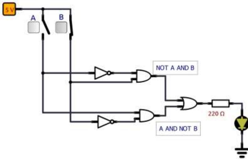
Quando si disegna il circuito con i simboli delle porte logiche prevedere sempre delle linee verticali, in corrispondenza degli ingressi, da cui staccare i rami orizzontali che vanno ai pin delle porte logiche.
