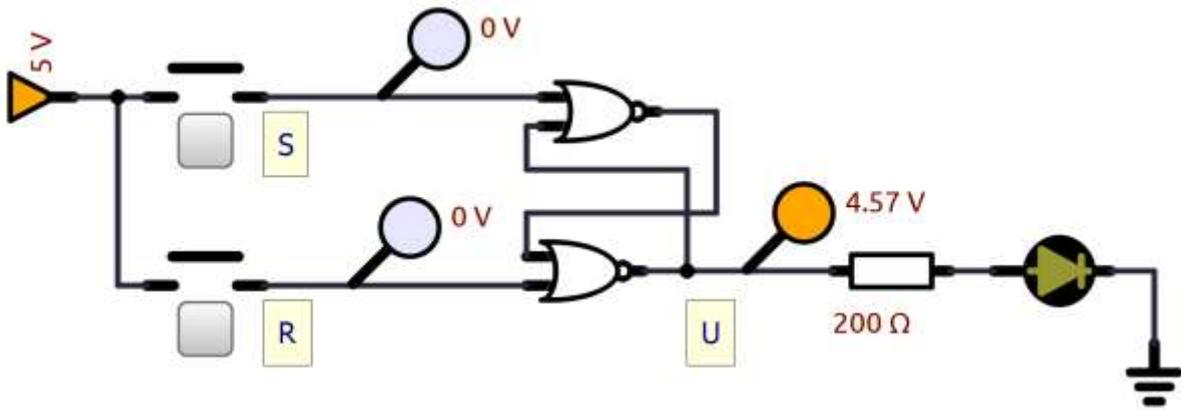
Circuito in Simulide per avviare un motore con autoritenuta.
