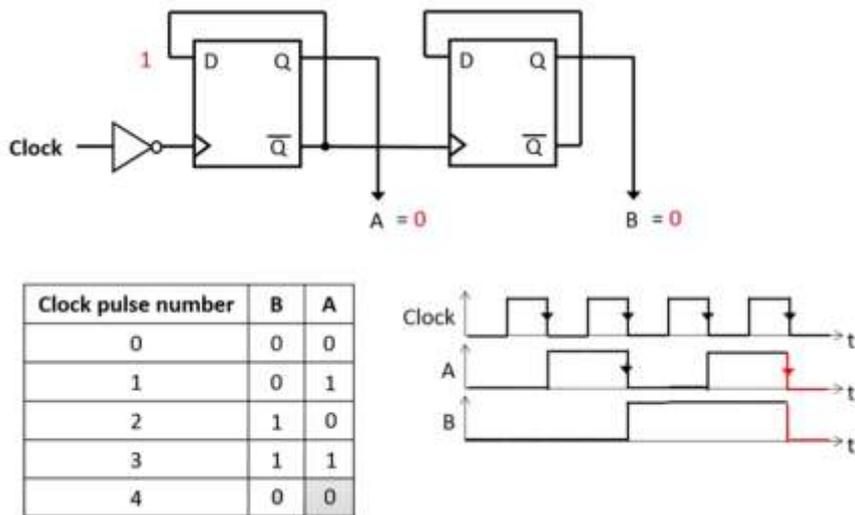
Simulazione con pulsante al posto di un CLOCK automatico.
