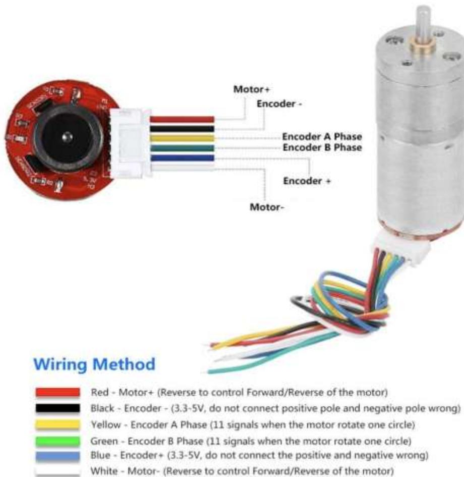
Quando il motore ruota, l'encoder integrato genera degli impulsi, ovvero segnali elettrici alternati di alta e bassa tensione. Ogni volta che il segnale passa da basso ad alto va conteggiato come un singolo impulso.
