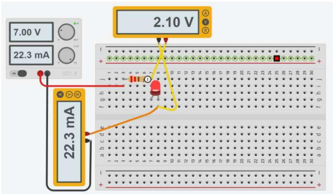
Variare la tensione di alimentazione partendo da 1V con passo 0,5V fino al valore che causa una corrente nel circuito di +/- 20mA.
