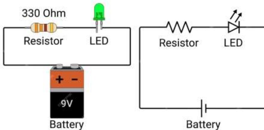
Fissata la corrente che deve scorrere nel diodo led (es.  $I = 20 \text{ mA}$ ) e nota la tensione di alimentazione  $V_{cc}$  si calcola la caduta di tensione sulla resistenza limitatrice  $R$ :
