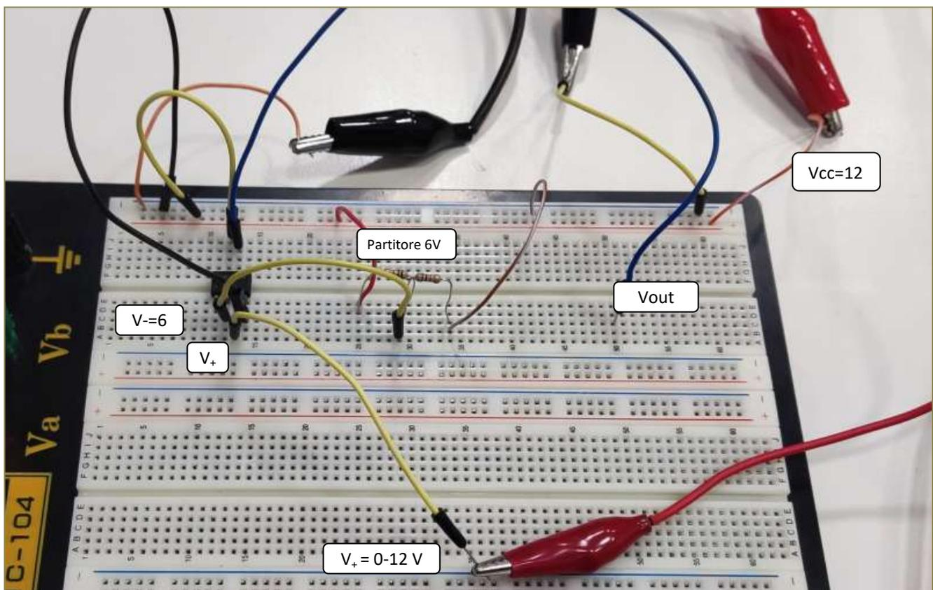
Un generatore di tensione a 12V alimenta l'OA mentre un secondo generatore genera la  $V_+$ . La tensione  $V_- = -6V$  viene ottenuta tramite un partitore di tensione (1K+1K). Quando  $V_+ > V_-$  l'uscita va ALTA a 11.3V e accende il LED.
