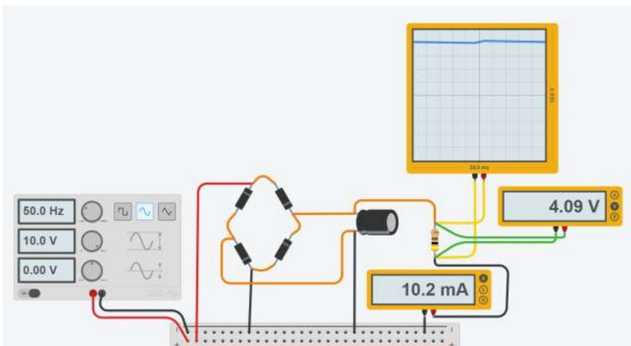
La capacità che deve avere il condensatore di filtro, allo scopo di livellare la tensione in uscita e ridurre le ondulazioni, può essere calcolata con buona approssimazione anche usando la formula seguente:
