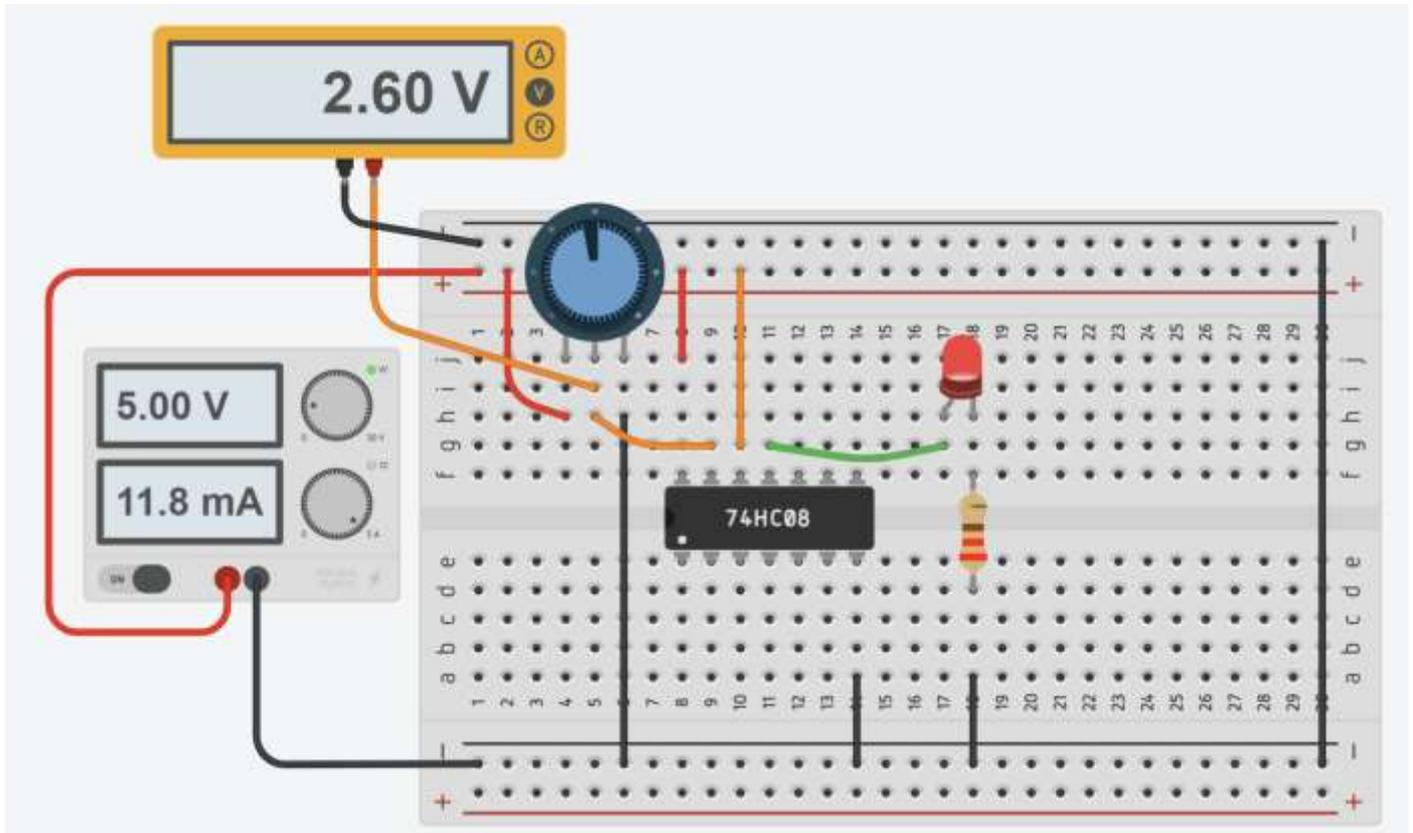
I test effettuati sulla porta logica a disposizione indicano una  $V_{ih}$  di circa 2.3V e una  $V_{il}$  di 1.8V.
