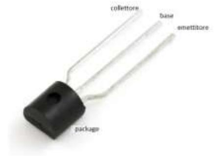
I terminali delle tre regioni vengono metallizzati per creare i contatti che successivamente usciranno dal package del componente per poter essere saldati sulla scheda elettronica.
