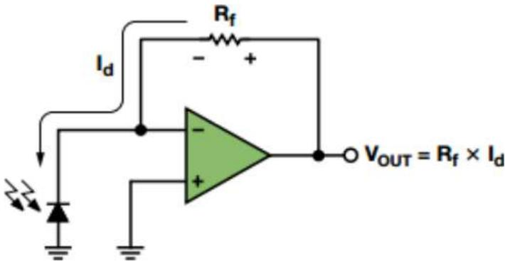
Questo circuito fa funzionare il fotodiodo in modalità fotovoltaica, dove l'amplificatore operazionale mantiene la tensione ai capi del fotodiodo a 0 V. E' la configurazione più comune per applicazioni di precisione. La curva tensione/corrente del fotodiodo è molto simile a quella di un diodo normale, con l'eccezione che l'intera curva si sposterà verso l'alto o verso il basso al variare del livello di luce.
