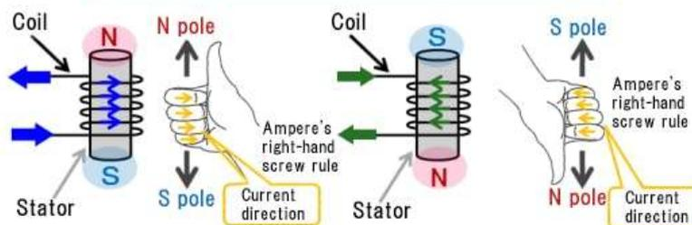
Con il motore a spazzole la rotazione si ottiene controllando i campi magnetici generati dalle bobine sul rotore, mentre il campo magnetico generato dai magneti stazionari rimane fisso. Per modificare la velocità di rotazione, si varia la tensione delle bobine.
