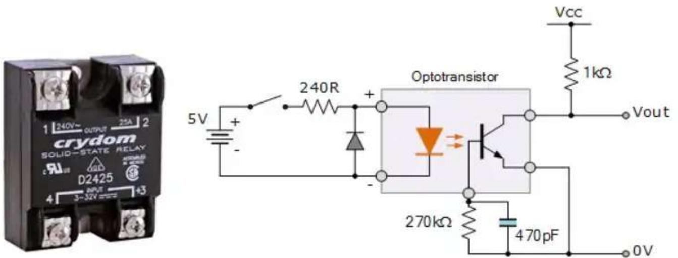
Un relè a stato solido è un dispositivo elettrico di commutazione che, attraverso l'utilizzo di un fotoaccoppiatore, trasmette e fornisce elettricità all'uscita.
