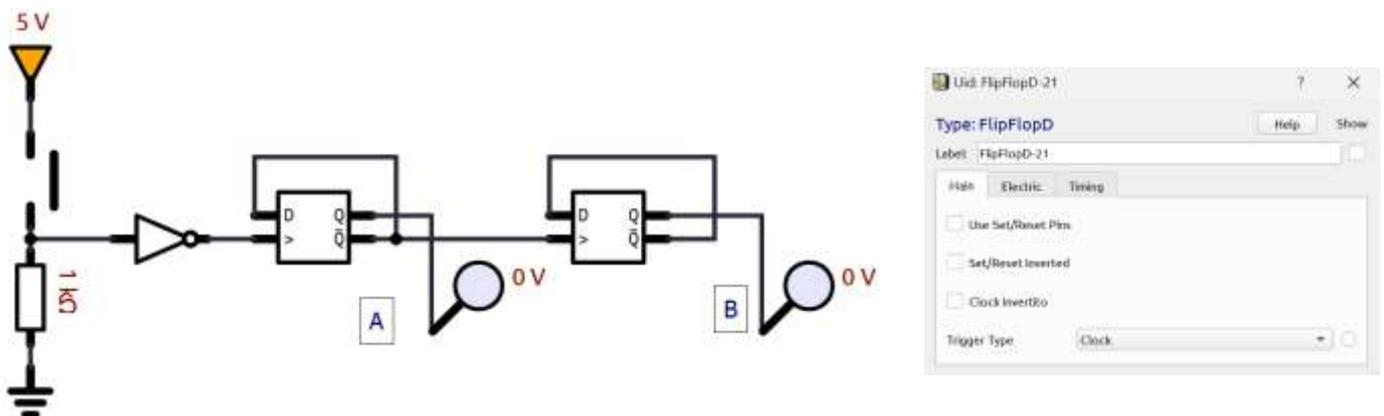
**ESERCIZIO:** attivare un sistema di allarme quando sono stati contati 4 pezzi in un sistema di monitoraggio.
