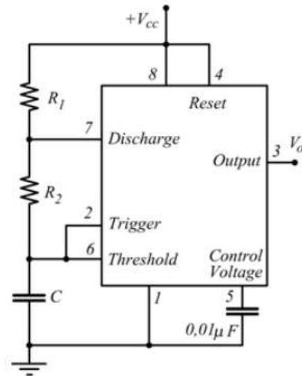
La tensione sul condensatore C oscilla tra  $1/3V_{cc}$  e  $2/3V_{cc}$  e l'uscita tra 0 e  $V_{CC}$ .
