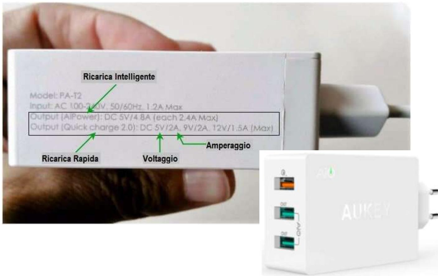
La porta arancione ha una uscita con ricarica veloce, essendo capace di ricaricare dispositivi compatibili con questo sistema a tensioni più elevate: da 9V e 12V con Quick Charge 2.0.
