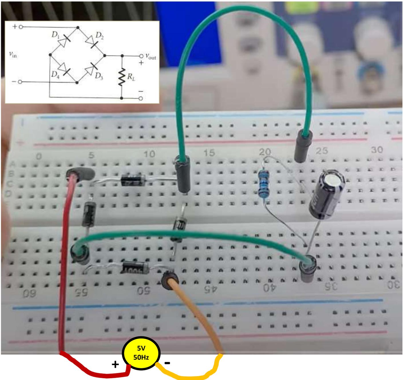
L'onda in ingresso può arrivare da un generatore di funzioni d'onda che consente di regolare sia la frequenza che l'ampiezza del segnale in tutta sicurezza.
