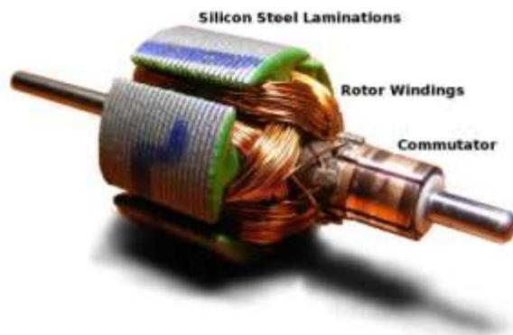
Le spazzole fisse forniscono energia elettrica al commutatore rotante.
