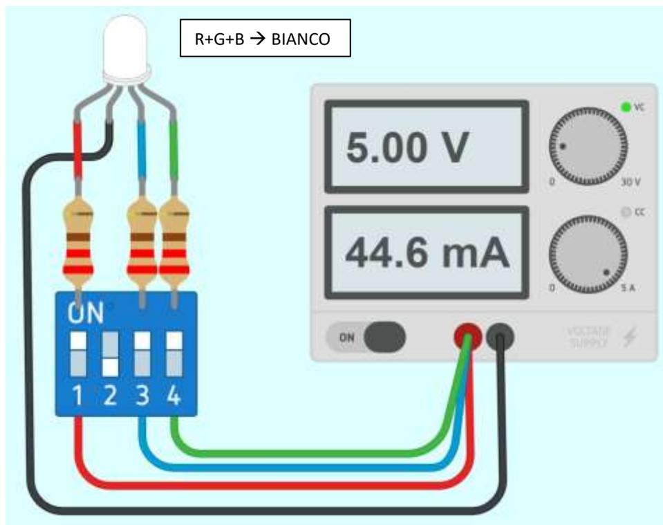
Se si vogliono sfumature di colore o passaggi graduali da un colore ad un altro occorre variare la corrente circolante in ciascun LED. Si possono mettere dei potenziometri al posto degli interruttori in modo da permettere di ridurre la corrente, quindi la singola luminosità, di ciascuno dei 3 LED.
