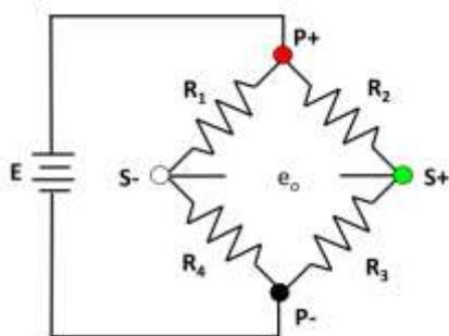
$E$  = tensione di alimentazione del ponte,
