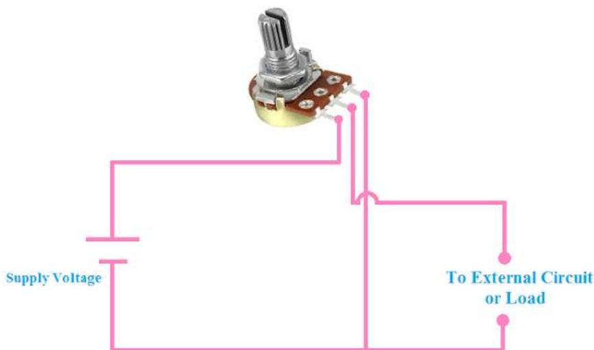
Nello schema elettrico sopra, puoi vedere che c'è solo un resistore nel potenziometro ma il cursore ha diviso il resistore in due.
