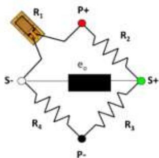
È da notare che le resistenze che vengono usate per completare il ponte, nel caso delle configurazioni a quarto di ponte e a mezzo ponte, non sono delle resistenze commerciali, ma bensì resistenze di precisione con un coefficiente di temperatura di  $\pm 1$  ppm/°C (per quelle commerciali il coefficiente è pari a  $\pm 400$  ppm/°C).
