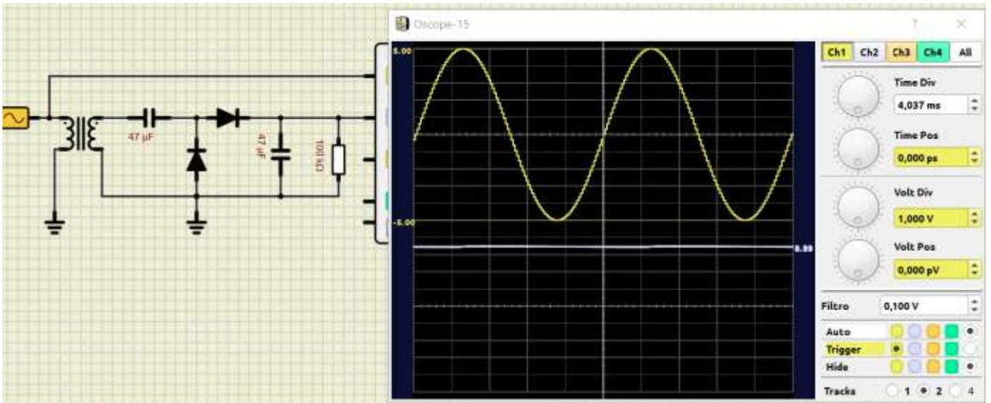
In presenza di un carico che assorbe corrente la tensione in uscita si riduce ed evidenzia una oscillazione (carica e scarica).
