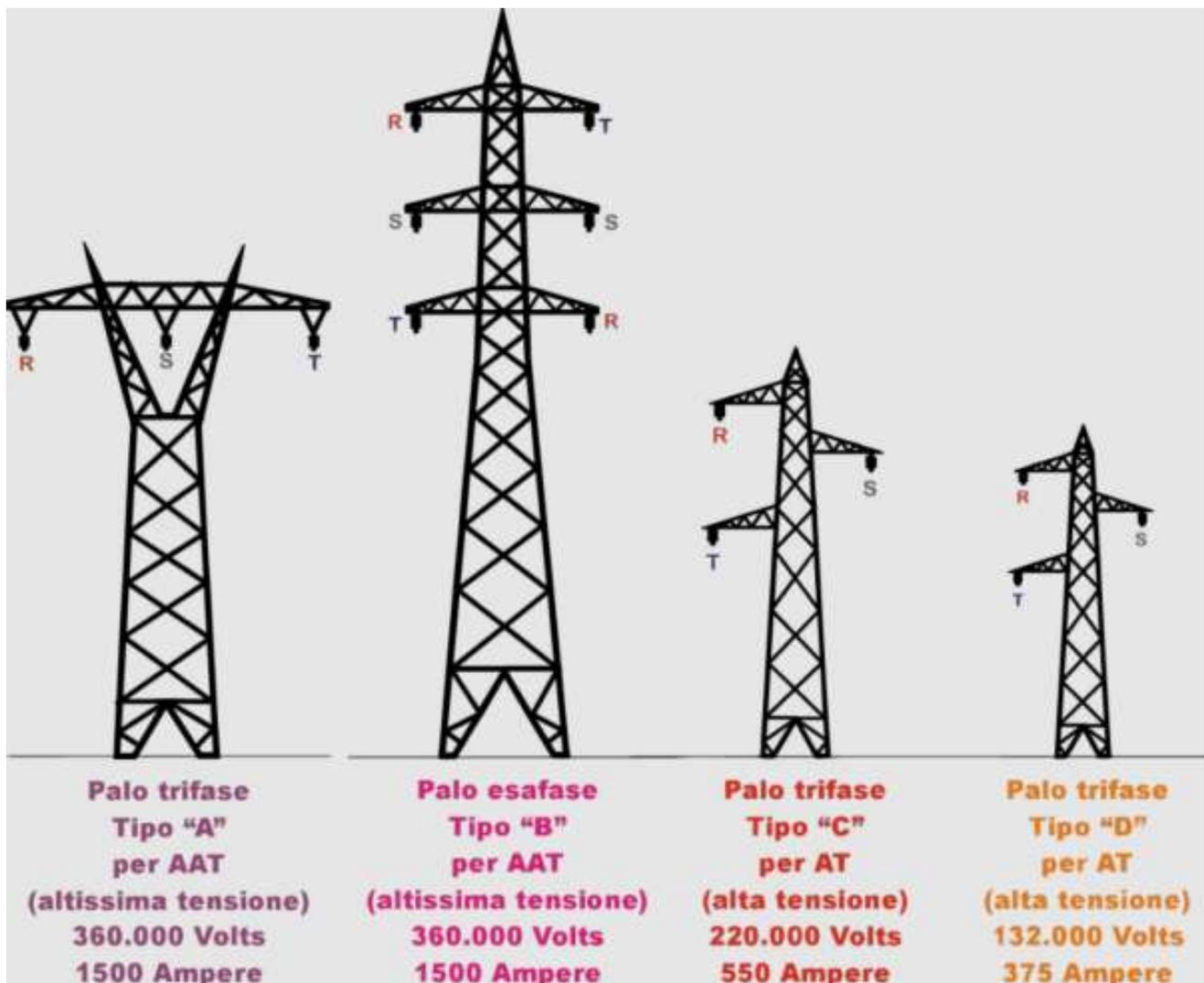
Le linee in alta tensione sono sempre costituite da 3 conduttori, ciascuno formato da una treccia di rame con all'interno un'anima di acciaio, che serve per sostenere il peso della linea.
