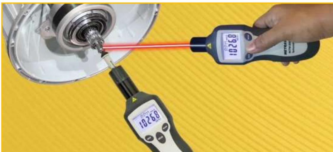
I Tachimetri Digitali di tipo senza contatto possono misurare la velocità a distanza e vengono utilizzati per misurare i giri, le rotazioni o la velocità, utilizzando laser, infrarossi o altri tipi di sorgenti luminose.
