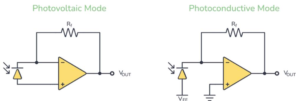
Nel circuito fotovoltaico si collega il fotodiodo in modalità polarizzata direttamente. L'anodo del fotodiodo è collegato al terminale non invertente e il catodo al terminale invertente dell'amplificatore operazionale. Quando la luce cade sul fotodiodo, genera una piccola tensione e corrente. L'amplificatore operazionale lo amplifica ed emette una tensione.
