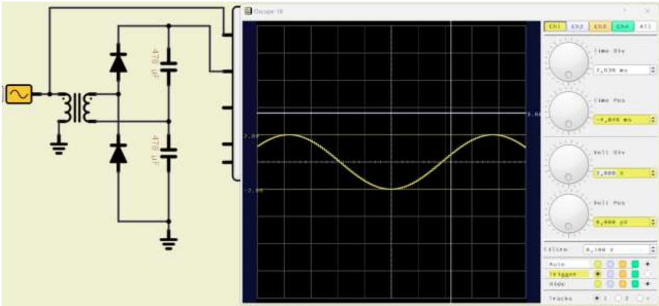
Dalla figura sottostante si può vedere la fase transitoria iniziale di carica del primo e poi del secondo condensatore.
