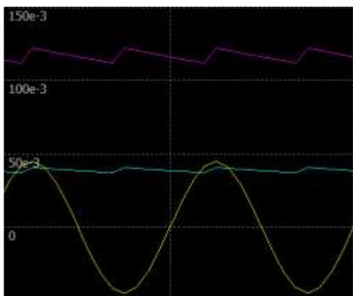
Se si abbassa la  $R_c$  a 100 ohm aumenta la corrente assorbita e di conseguenza anche il ripple (circa 1V).
